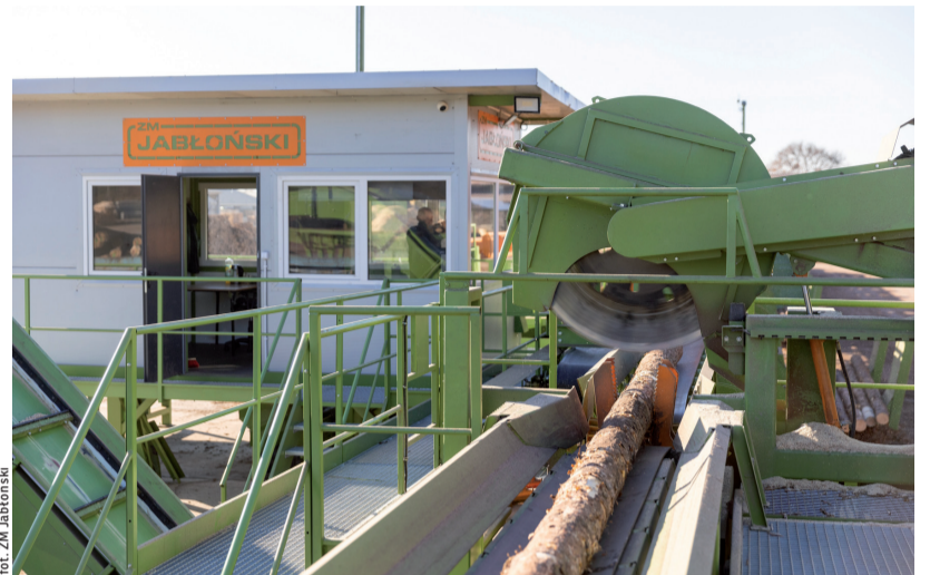
Dzięki wykorzystaniu choćby systemu skanowania 3D, udaje się tak zoptymalizować cięcie surowca, by w pełni go wykorzystywać, bez powstawania zbędnych produktów ubocznych.
