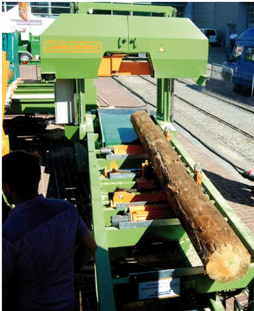
Operator cały czas obserwuje łożę maszyny i kłody na nim.
