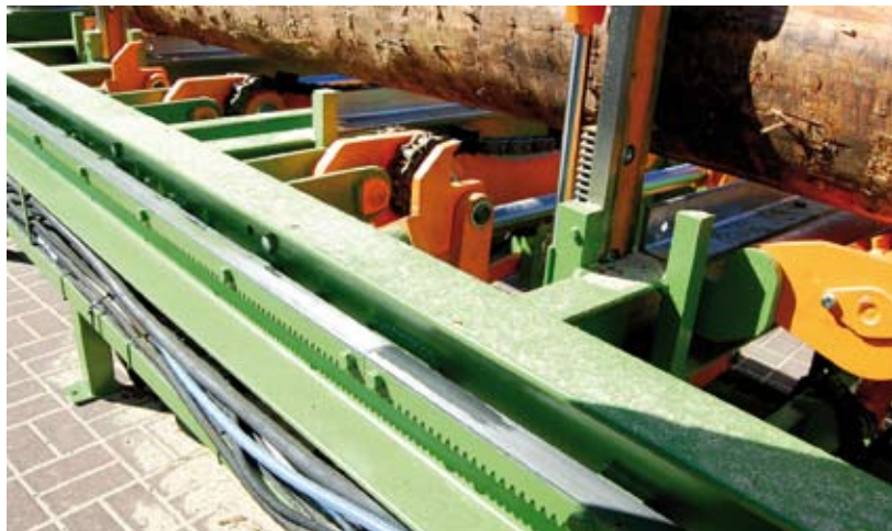
Poruszanie ramy z zespołami obróbczymi jest wykonywane po obrabianych bieżniach.
