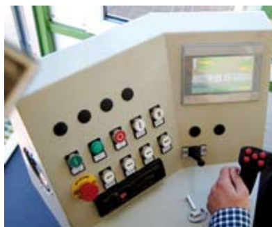
Wszystkie przyciski oraz joysticki operator ma w zasięgu rąk.
