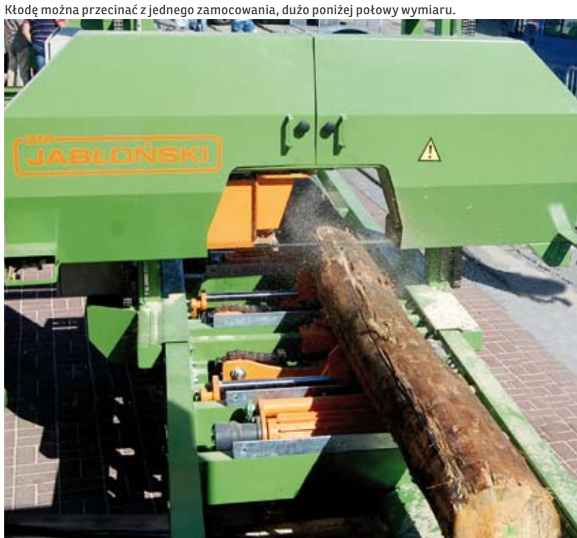
Kłodę można przecinać z jednego zamocowania, dużo poniżej połowy wymiaru.
