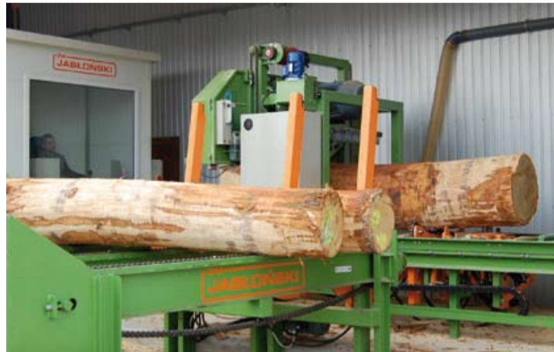
Pilarka wyposażona jest w firmie Telejki w rampę załadowniczą, umożliwiającą magazynowanie materiału wejściowego i automatyczne podawanie pojedynczej kłody na stół obróbczy maszyny.
