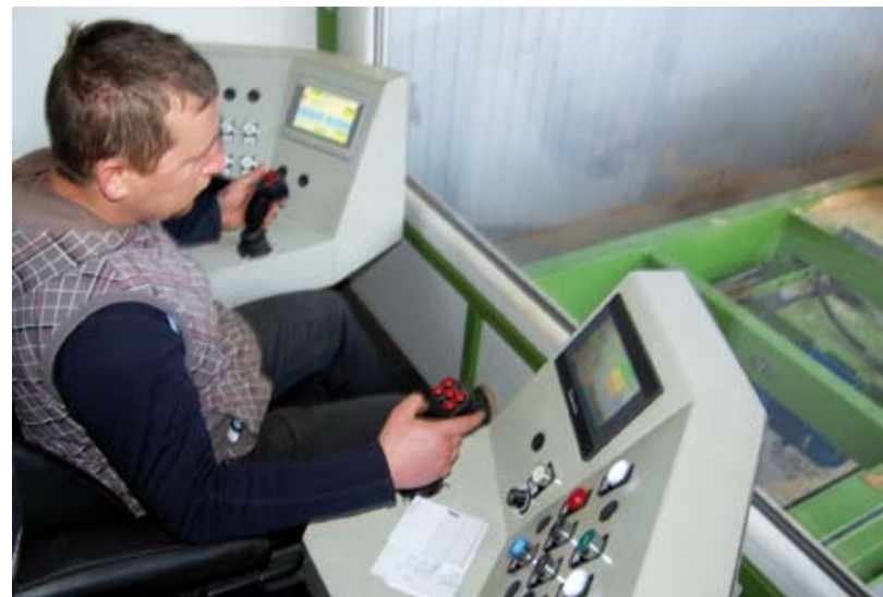
Operator ma możliwość płynnego sterowania szybkością ruchów poszczególnych operacji, dzięki czemu może szybko i precyzyjnie ustawić nawet największą kłode.
