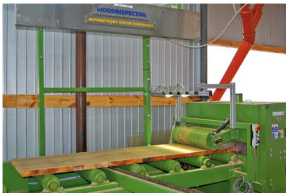
Innowacyjne rozwiązanie, umożliwiające automatyczny pomiar szerokości deski bezpośrednio za trakiem i szrotkarką.
