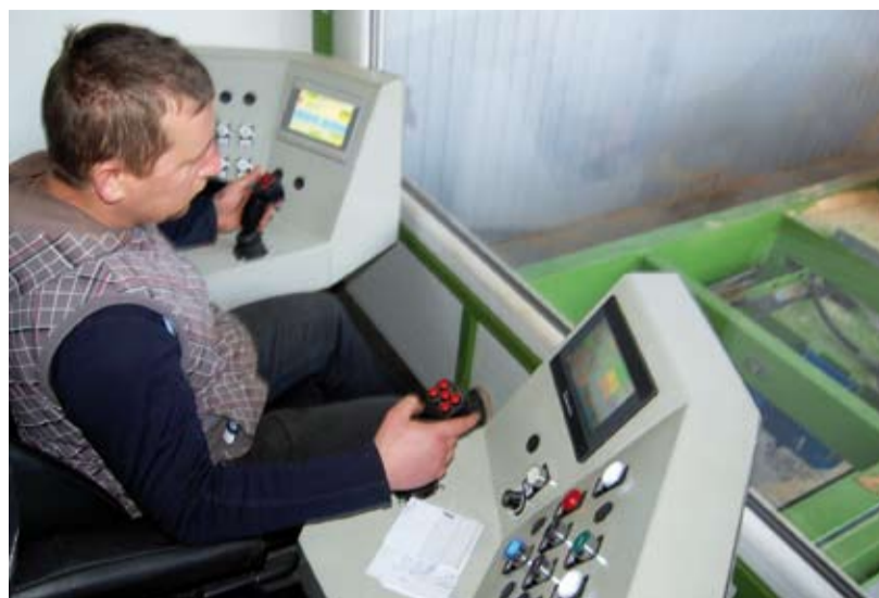
Operator ma możliwość płynnego sterowania szybkością ruchów poszczególnych operacji, dzięki czemu może szybko i precyzyjnie ustawić nawet największą kłodę.
