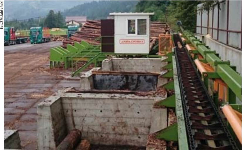
W skład linii wchodzi: rampa podawcza, rampa unosząca, zapewniająca podawanie kłód po jednej sztuce, podajnik łańcuchowy osiowy wraz z kurtyną pomiarową i stacją kapującą.
