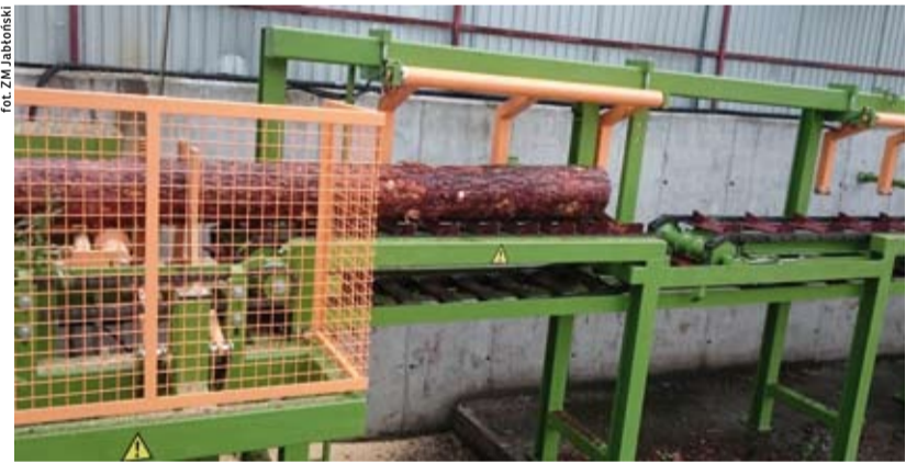
Do cięcia drewna wykorzystano piłę łańcuchową.
