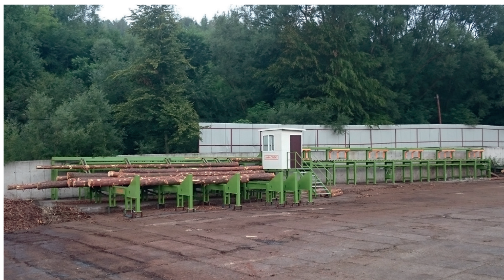
Dzięki linii do przetarcia nie trafiają kłody zróżnicowane, ale o konkretnym zakresie średnic, co przekłada się na lepszą optymalizację i wykorzystanie drewna.
