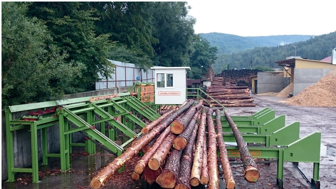
Linie kapująco-sortujące ZM Jabłoński produkowane są w wersji do kłód o średnicy maks. 58 cm i 80 cm.
