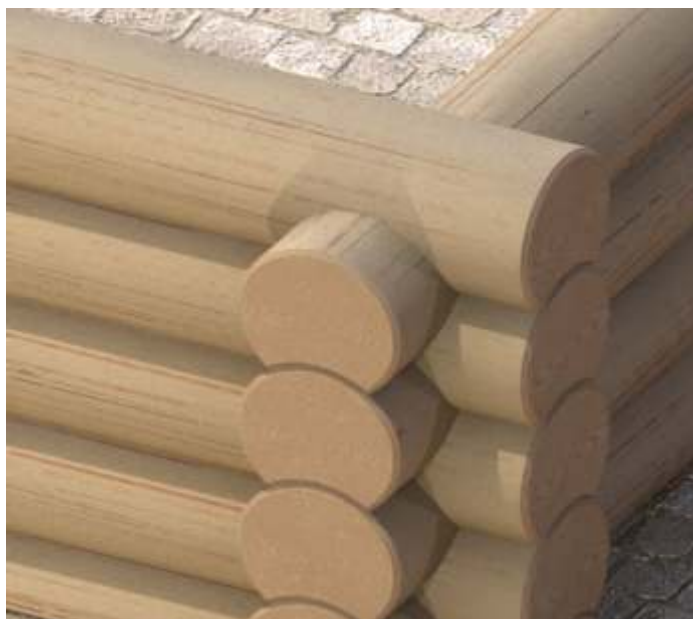
Narobienie ciany wieńcowej z zacięciem kiesiencycowy z ostatkami.
