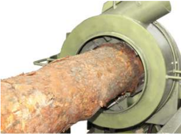
Linia do produkcji bali w technologii okrągłego z dolnym wyłobieniem.
