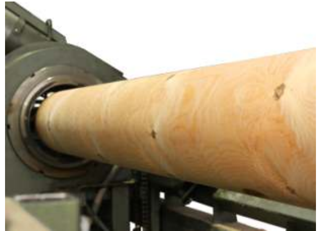
Linia do produkcji bali w technologii okrągłego z dolnym wyłobieniem.
